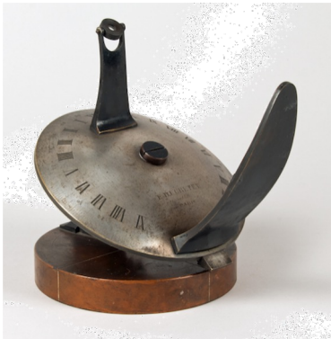
Héliochronomètre de type Fléchet
