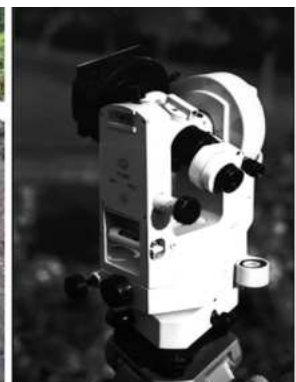
Mon « théo »... Bien visibles sont la « libellule » (niveau à bulle circulaire), la lunette, le microscope, le filtre et les divers boutons de réglage fin.
