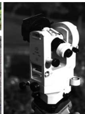
Mon « théo »... Bien visibles sont la « libellule » (niveau à bulle circulaire), la lunette, le microscope, le filtre et les divers boutons de réglage fin.
